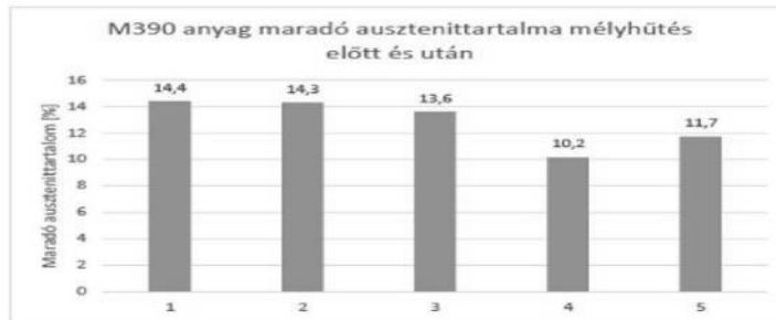
21. diagram: M390 anyagminőség maradó ausztenittartalma a mélyhűtés előtt és után Jelmagyarázat: 1,2,3: mélyhűtés előtt; 4,5: mélyhűtés után
