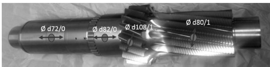
7. ábra: Előtét tengely felületén mért maradó feszültség mérési helyek és a meghatározott feszültség iránya
